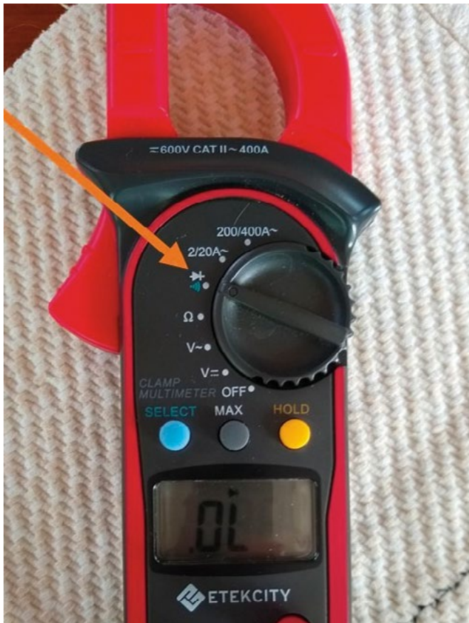
Figure 3. VOM Testing a Diode
