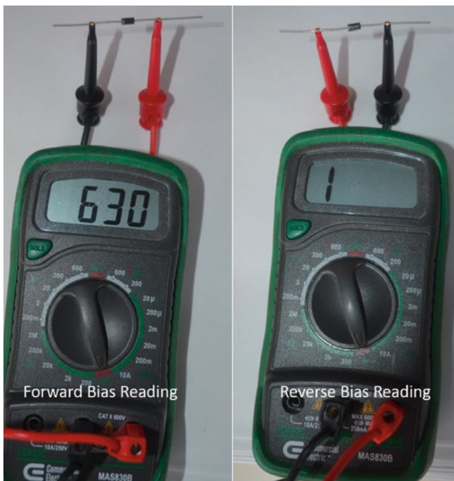
Figure 3. VOM Testing a Diode
